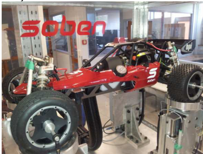
Fig 2 : Mini véhicule équipé de suspensions semi-actives
